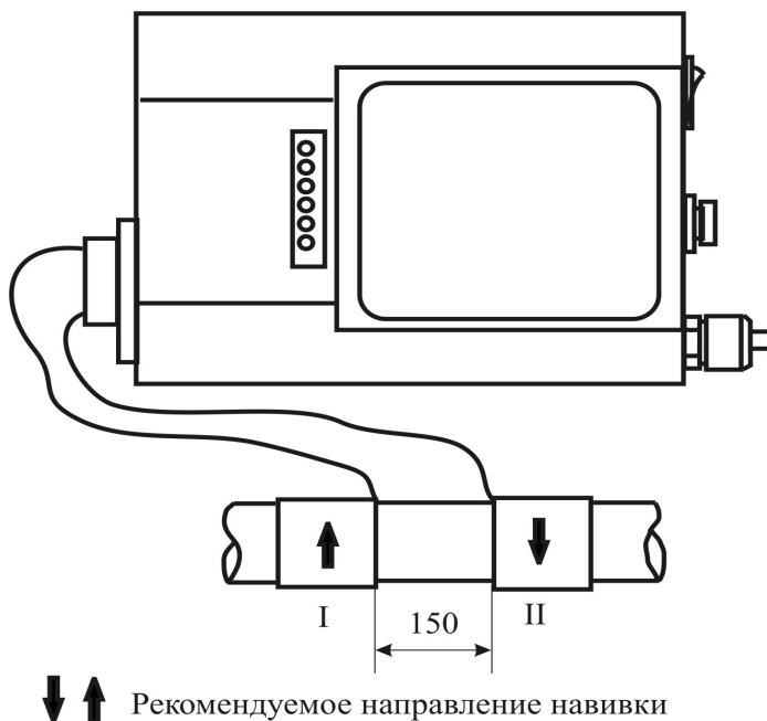
Рисунок 1 Условная схема монтажа прибора и проводов излучателей.
